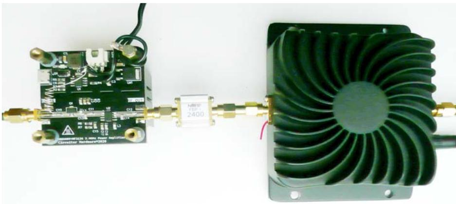
30dB Vorverstärker    Bandpass 2,4GHz    Endstufe
