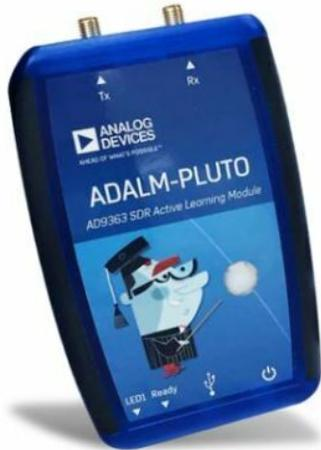
Der Adalm-Pluto<sup>6</sup> liefert 5mW Ausgangsleistung und verfügt über separate Anschlüsse für den Sende- und Empfangszweig. Als Benutzeroberfläche verwende ich die SDR-Console, der Anschluß an den PC erfolgt über die USB-Schnittstelle. Damit sind schon erste Versuche im gesamten Frequenzbereich möglich, durch die Voll duplex-Fähigkeit kann man sein eigenes Signal empfangen.
