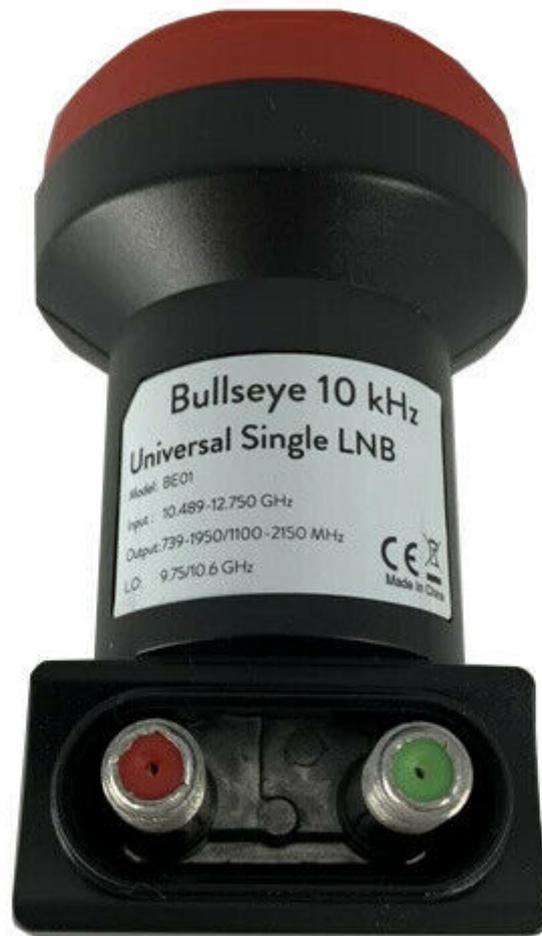
Der Preis beträgt ca. 25€, allerdings hat der TCXO eine Abweichung von 2ppm, was aber geringer ist als der eines unmodifizierten LNB. Ich werde den LNB für meine Portabel-Station einsetzen
