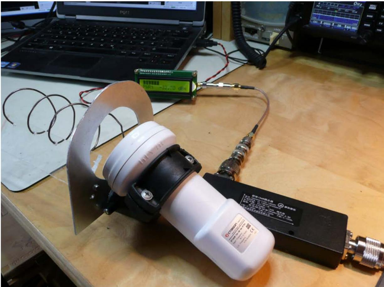
Er besteht aus einem Richtkoppler, mehreren Dämpfungsgliedern und einer Leistungsanzeige. Zuerst wird die vorlaufende Leistung gemessen, dann werden Ein- und Ausgang des Richtkopplers vertauscht und die rücklaufende Leistung gemessen. Aus der Differenz ergibt sich die Rücklaufdämpfung und somit das SWR. Zum Abgleich wird die Helix entsprechend korrigiert. Vorlauf bei 2400 MHz -8dB, Rücklauf -32dB entspricht 24dB Rücklaufdämpfung = SWR 1.13 - auf Antrieb...
