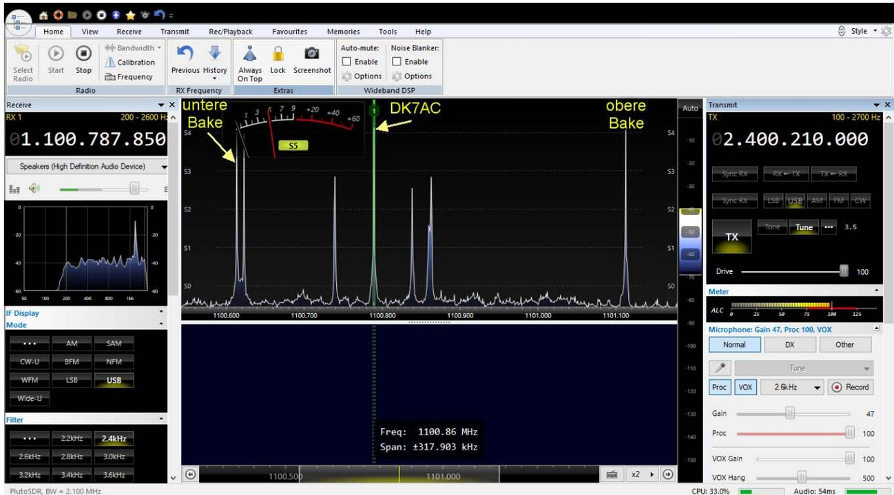
Der Bildschirm teilt sich in 4 Bereiche: Oben die Menus für Einstellungen, Speicher usw. Links das Empfangsfenster für die Einstellungen des RX, Rechts das Sendefenster mit den entsprechenden Einstellmöglichkeiten und in der Mitte die Spektrumanzeige und das Wasserfalldiagramm. In dieser Anzeige sind noch die direkten Frequenzen zu sehen.
