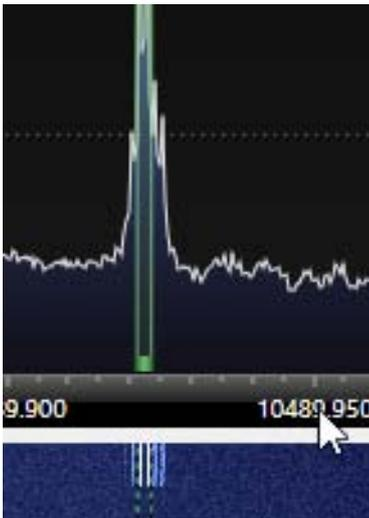
Nun spricht dem ersten qso nichts mehr entgegen, in der beschriebenen Konstellation kann die PA übersteuert werden, daher ist der Drive-Level zu reduzieren. Dies würde sich im Spektrum bei einem Zweitonsignal durch weitere Spektrallinien (s. Bild) zeigen. Bei mir ist die Einstellung des Drive-Level auf 70 optimal.
